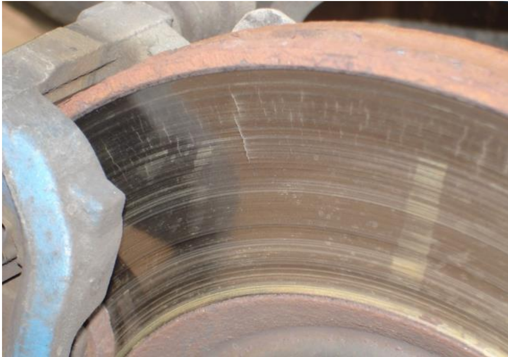
Ilustración 24: Disco de Freno Gastado
