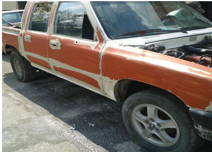
Ilustración 37: Masillado de la Carrocería
