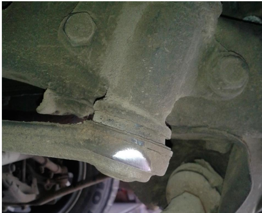
Ilustración 29: Componente de la dirección Desgastado
