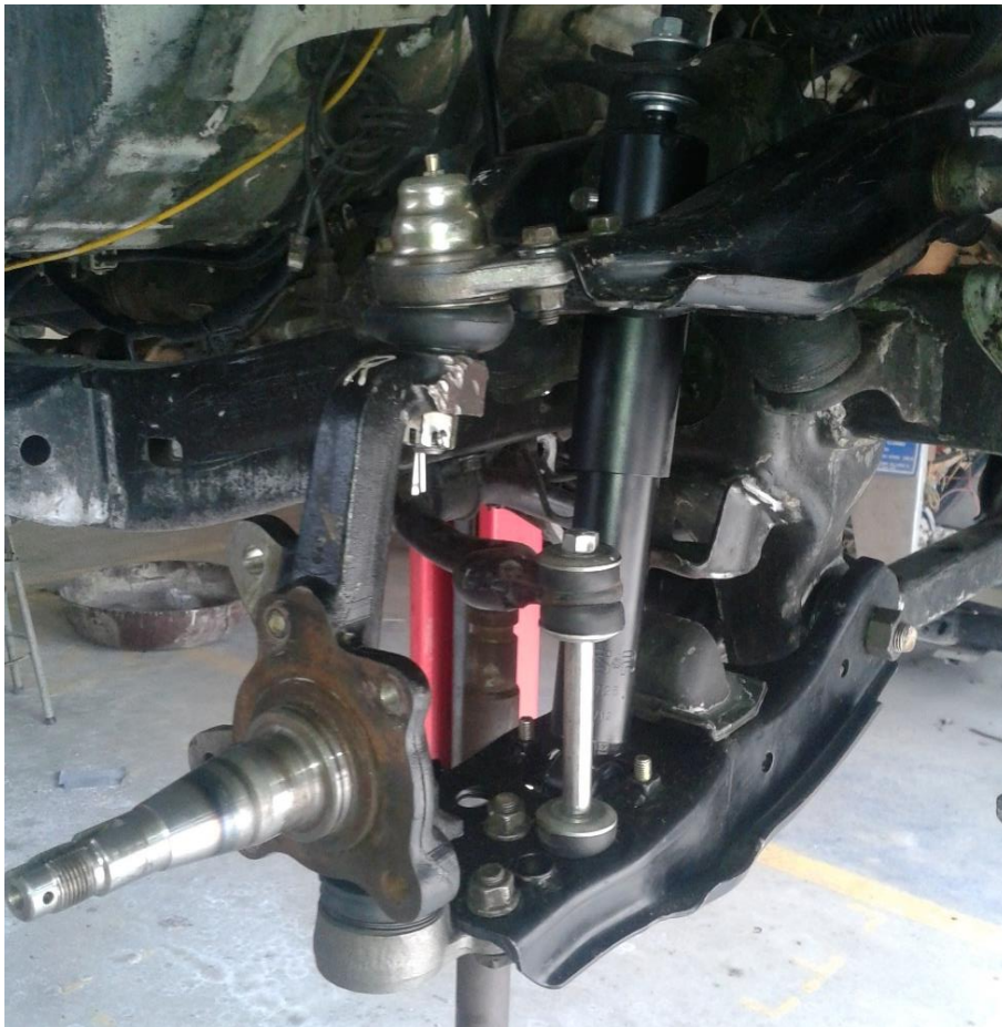
Ilustración 25: Sistema de suspensión Toyota Hilux 1998
