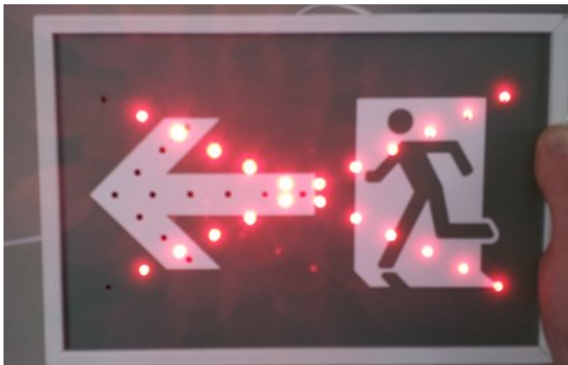
Figura 2.4 Señalética de Getaway indicando dirección a no seguir[9]
