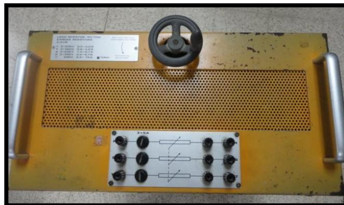
Figura 3. 4: Vista superior del banco resistivo MV1100
