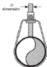
Pieza giratoria ajustable Argolla-varilla apretada a la tubería
