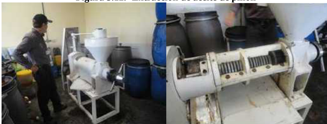
Figura 5.12.- Extracción de aceite de piñón
