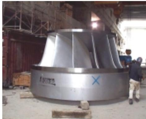
**Fig. 1.14: Alabes fijos de la turbina**
