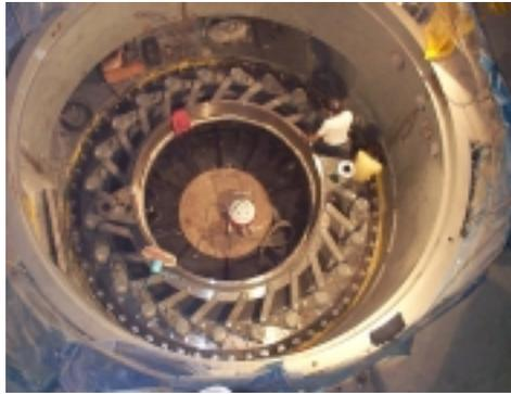
**Fig. 1.15: Conformación del distribuidor**
