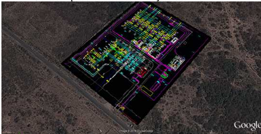
Gráfico 3 Ampliación de la subestación Posorja de 138/69kV a 150MVA
