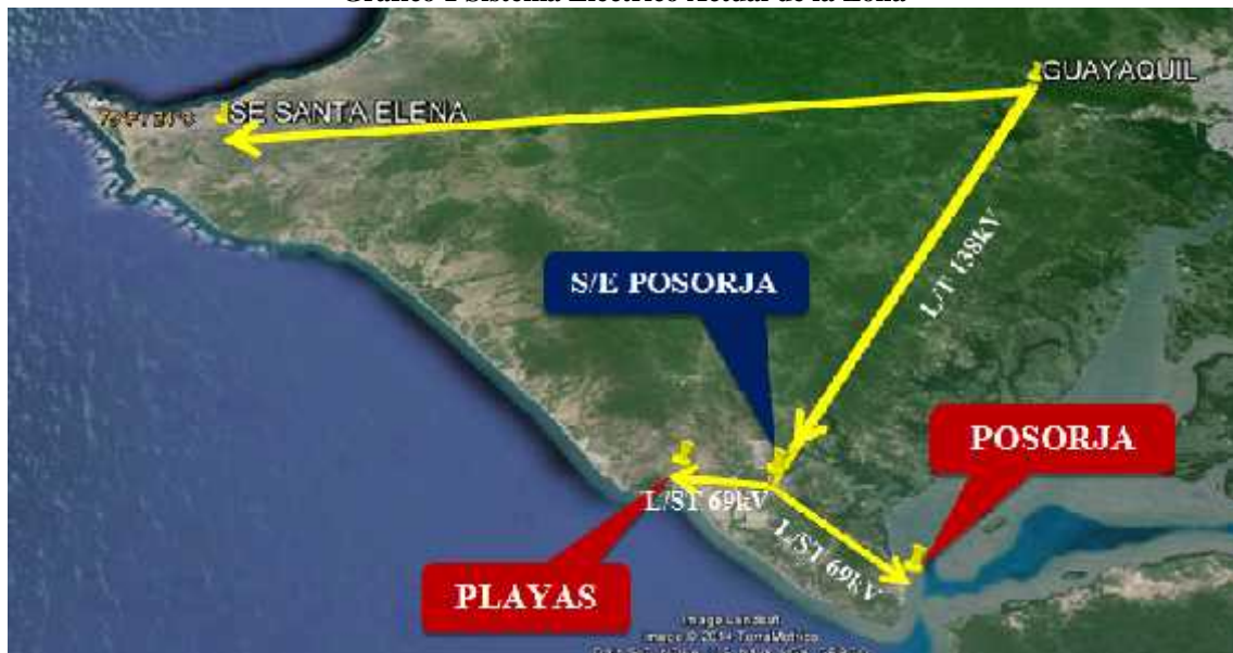
Gráfico 1 Sistema Eléctrico Actual de la Zona
