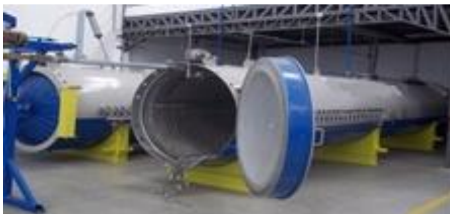
FIGURA 3.9 Armado y vulcanizado
