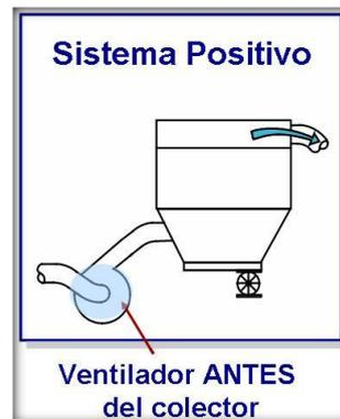
**FIGURA 3.11. SISTEMA DE PRESIÓN POSITIVA<sup>74</sup>**
