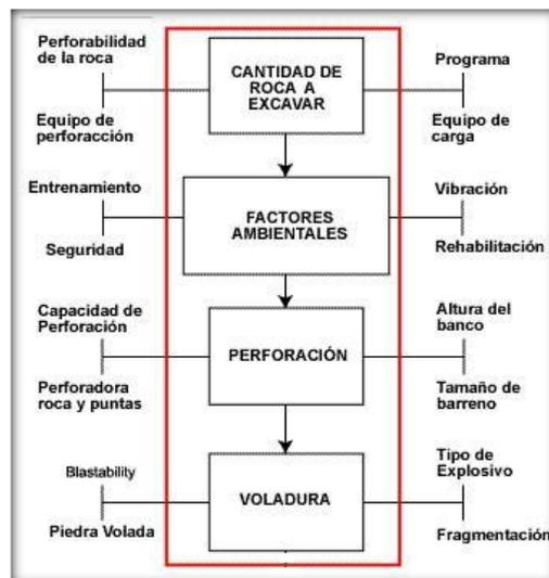
**FIGURA 2.4. PROCESO DE EXTRACCIÓN DE MATERIAS PRIMAS.**<sup>52</sup>
