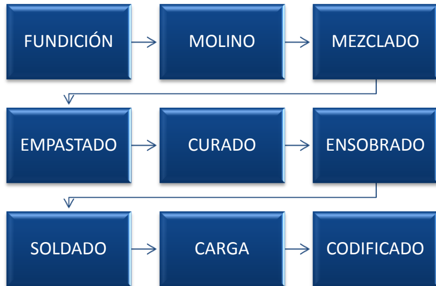
FIGURA 3.2. PROCESO DE ACUMULADORES ELÉCTRICOS DE PLOMO Y ÁCIDO
