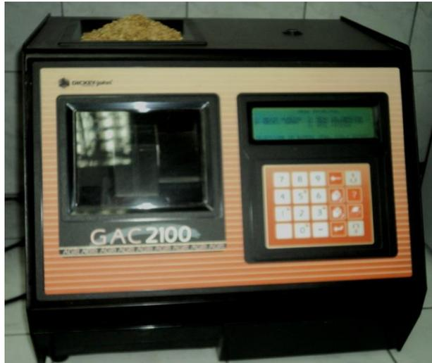
**FIGURA 3.5. MEDIDOR DE HUMEDAD GAC 2100**
