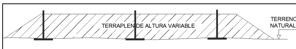
Gráfico 7. 29 Ubicación de Placas para control de asentamientos en obra.
