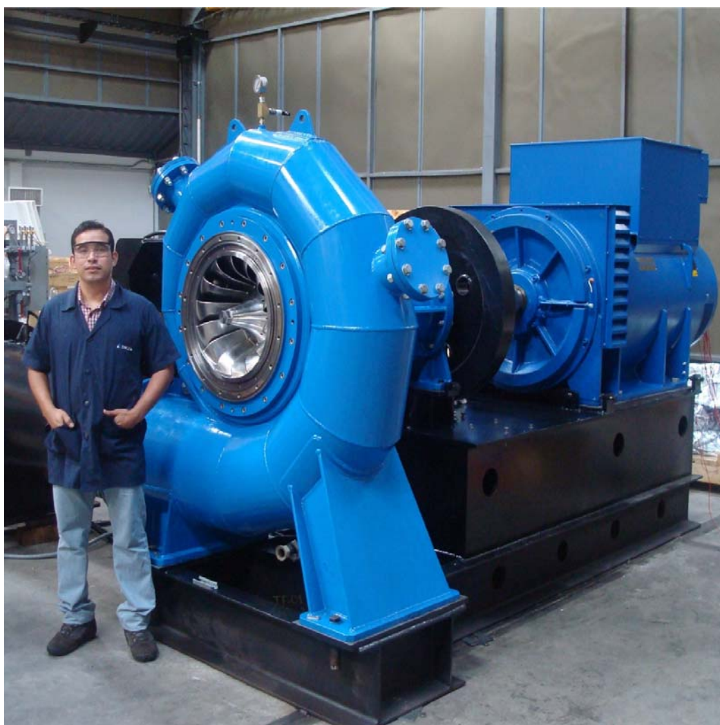
FIGURA 2.16 TURBINA FRANCIS PROYECTO HIDROMIRA, 1MW.
