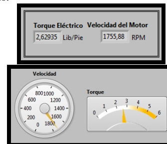
Figura 4.3: valores del torque eléctrico y velocidad del motor ( variador sin carga).
