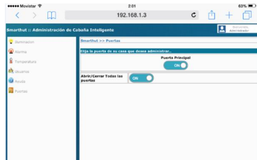
Figura 17. Control de Puerta Principal.
