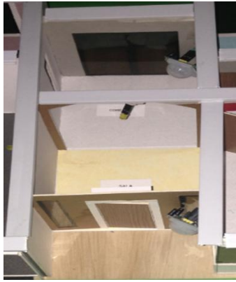
Figura 13. Ubicación de sensores de presencia.
