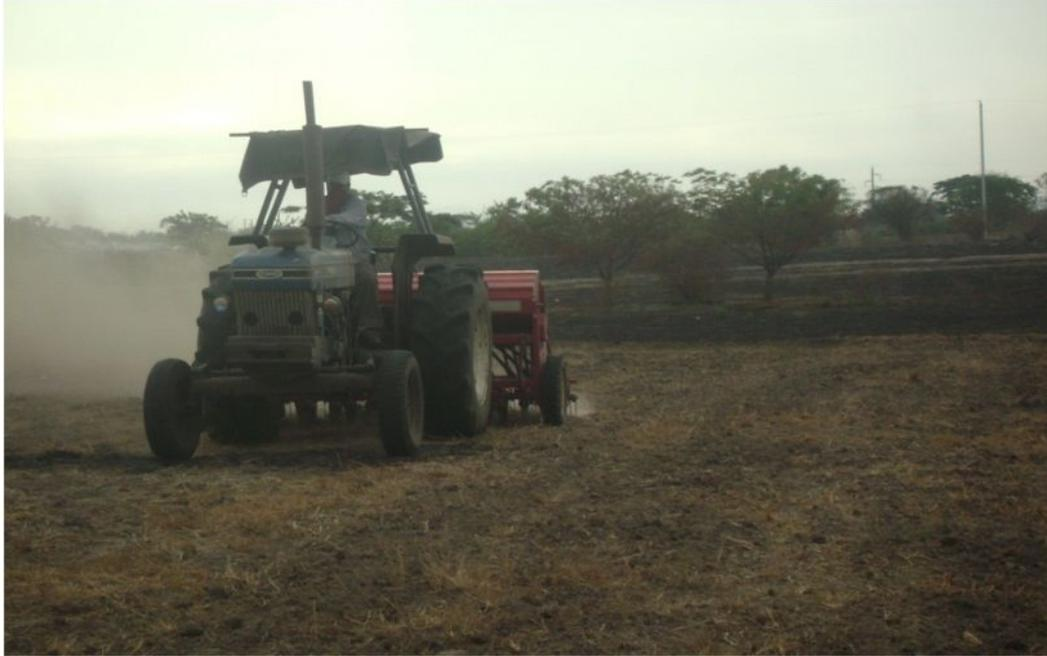
**Fotografía 1.** Vista completa de la sembradora de chorro continuo acoplada al tractor, en la labor de siembra del arroz. (Autor)
