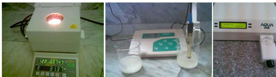
Figura.2.2 Equipos utilizados para medir pH y humedad
