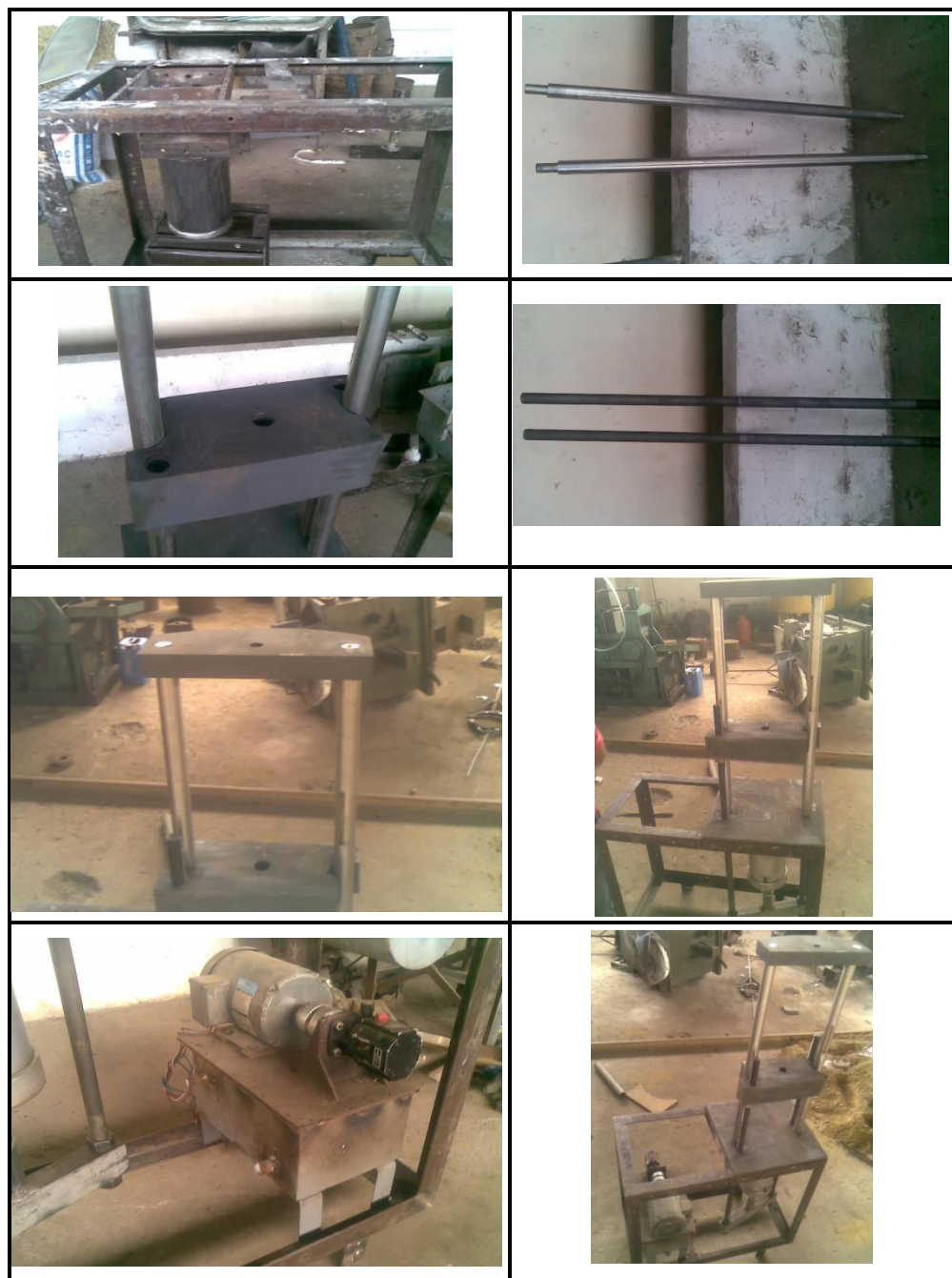
FIGURA 2.18 PROCESO DE CONSTRUCCIÓN DE CONJUNTO ESTRUCTURAL
