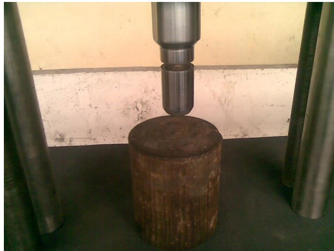
FIGURA 2.24 PENETRADOR PARA ENSAYOS EN ESCALA
