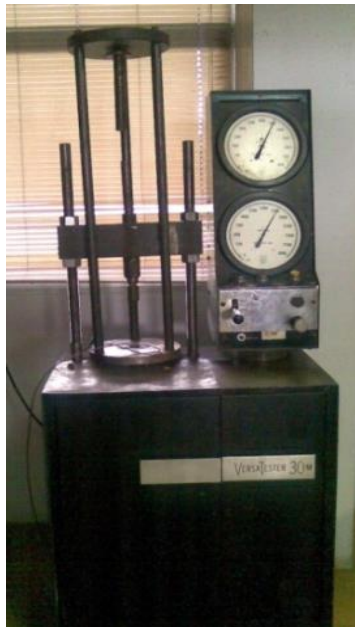
FIGURA 1.1 MÁQUINA VERSATESTER DESPUÉS DE LA REHABILITACIÓN MECÁNICA A LA QUE POSTERIORMENTE SE LE ELIMINARON LOS CONTROLES ANALÓGICOS.
