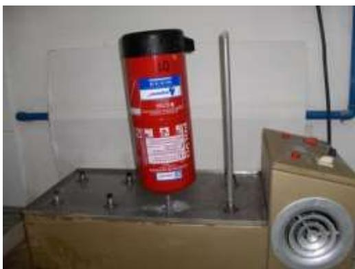
**FIGURA 7.8 MÁQUINA DE SECADO PARA EXTINTORES.**
