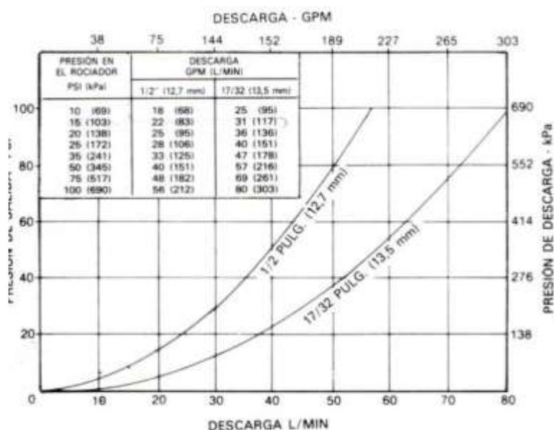
**FIGURA 5.2 DESCARGA DE AGUA DE UN ROCIADOR DE  $\frac{1}{2}$ " Y  $\frac{17}{32}$ " DE ORIFICIO NOMINAL**
