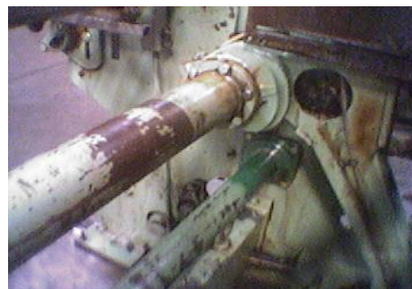
FIGURA 3.27. Ejes de Cigüeñal y Torsión.
