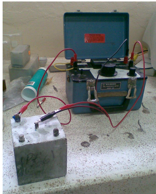
FIGURA 1.11 MEDICIÓN DE RESISTENCIA
