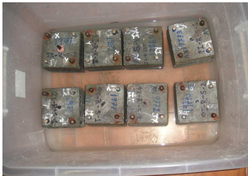
FIGURA 1.9 PROBETAS INMERSAS EN CLORURO DE SODIO
