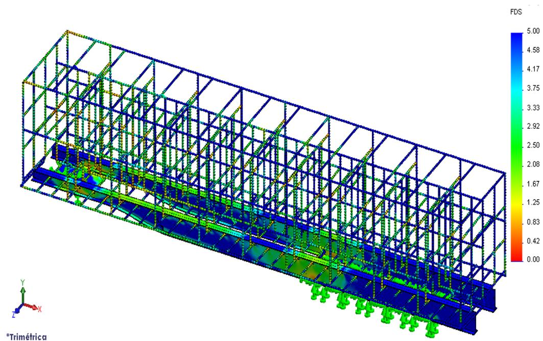
**Figura 3.24. FACTOR DE SEGURIDAD DEL MODELO RANGO 0-5**
