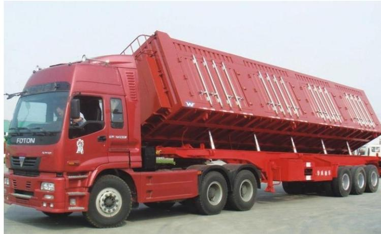
**Figura 1.6. SEMIRREMOLQUE BASCULANTE LATERAL**
