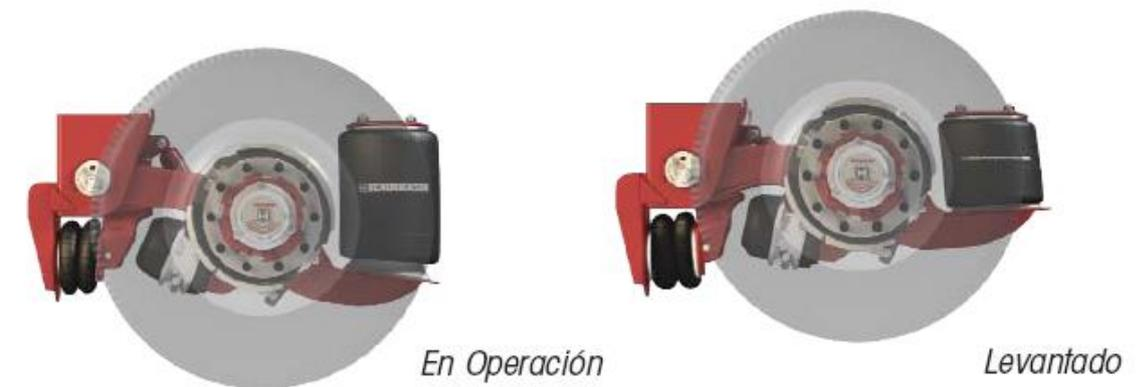
**Figura 3.27. OPERACIÓN DEL SISTEMA DE LEVANTE**
