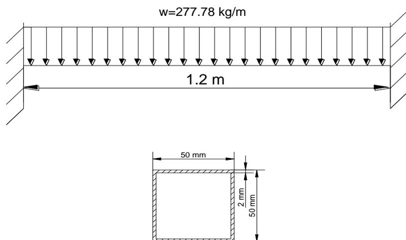
**Figura 3.2. GRÁFICA DE LAS CARGAS QUE ACTÚAN SOBRE LA VIGA**
