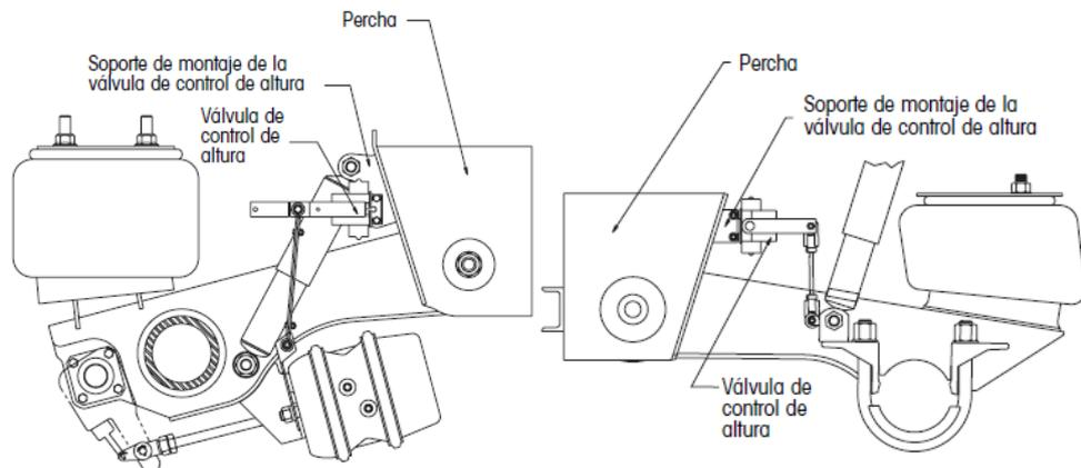
**Figura 3.29. VÁLVULA DE CONTROL EN SUSENSIONES INTRAAX HT**
