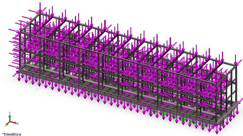
**Figura 3.19. APLICACIÓN DE CARGAS Y RESTRICCIONES AL MODELO**
