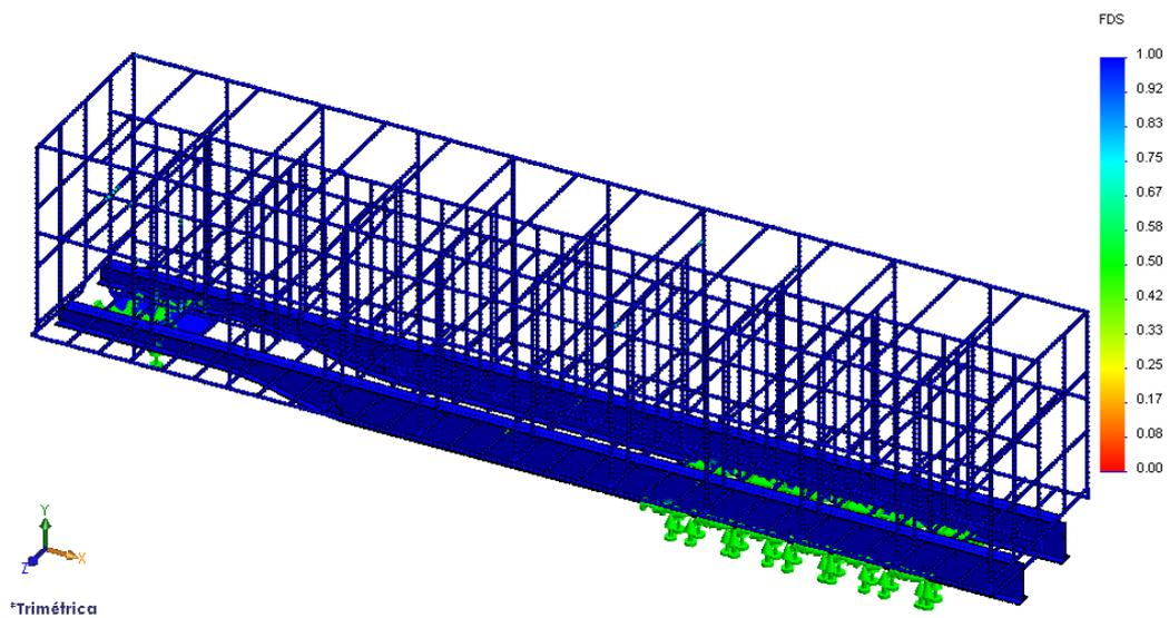
**Figura 3.23. FACTOR DE SEGURIDAD DEL MODELO RANGO 0-1**
