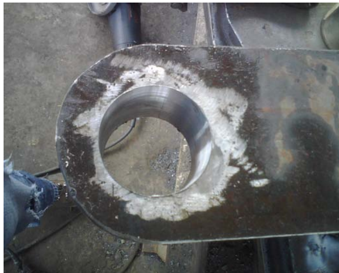
Figura A.10 Agujero cilíndrico mecanizado en fresadora
