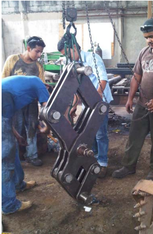
Figura A.18 Prueba de movimiento del mecanismo interno
