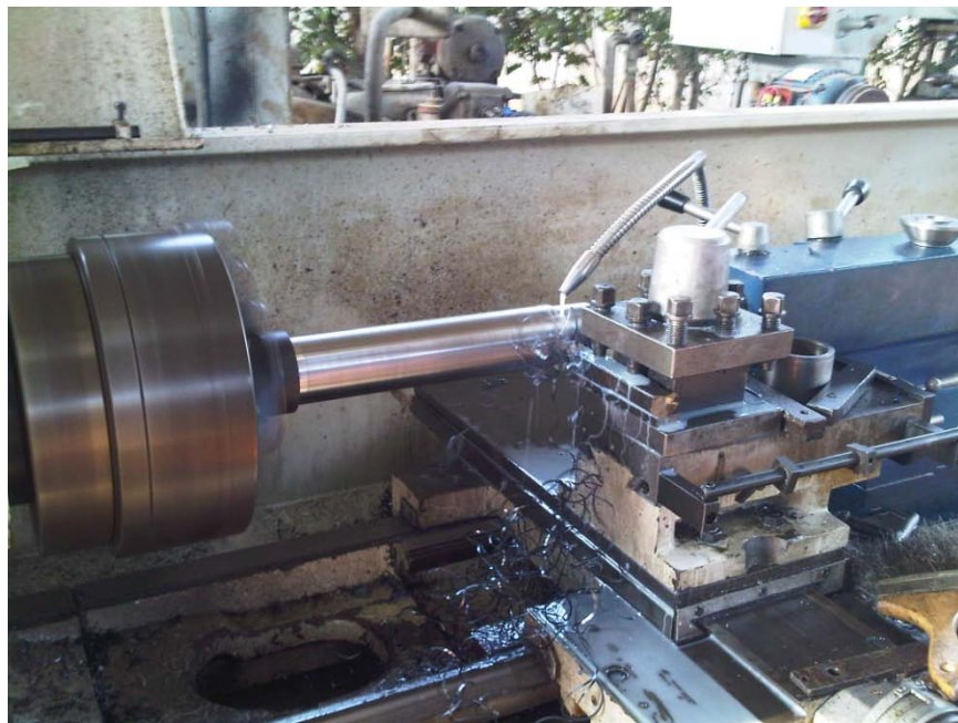
Figura A.9 Desbastado en el torno para dar forma a un pin
