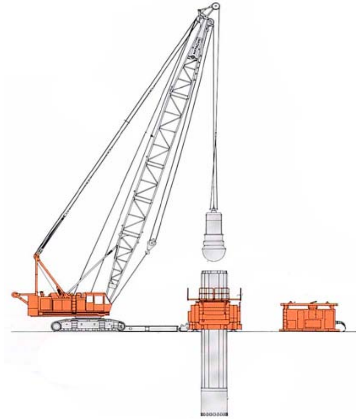
Figura 3.4 Metodología de excavación que muestra la importancia de la posición vertical del martillo excavador
