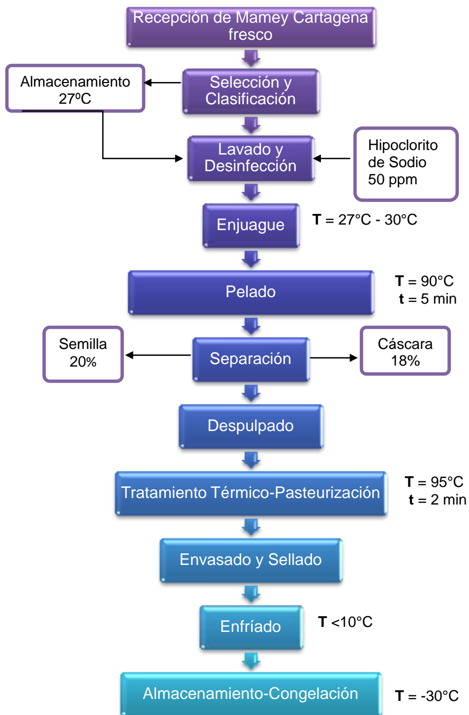
FIGURA 5.1 DIAGRAMA DE FLUJO PARA LA ELABORACIÓN DE PULPA CONGELADA DE MAMEY CARTAGENA
