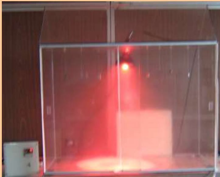
FIGURA 2.2 CAMARA GENERANDO NIEBLA SALINA
