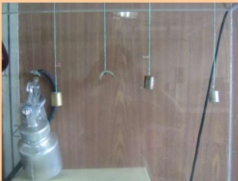
FIGURA 2.3 MUESTRAS EN LA CAMARA DE NIEBLA SALINA
