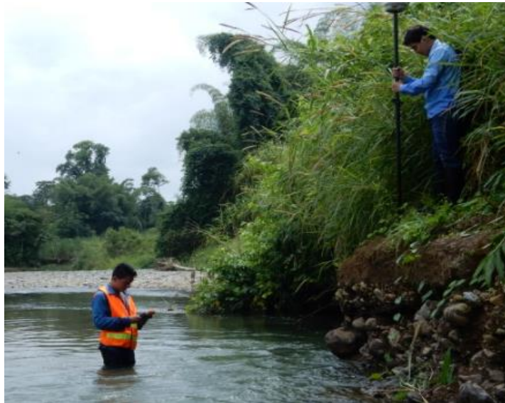
Fotografía 13.- Levantamiento Topográfico del río Chagüe Tomado por el autor
