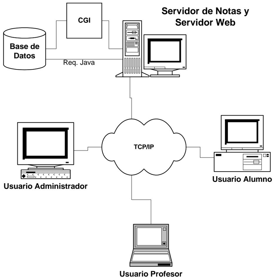
**Fig.1.1.** Ilustración de la arquitectura Cliente - Servidor del Sistema de Administración de Cursos.
