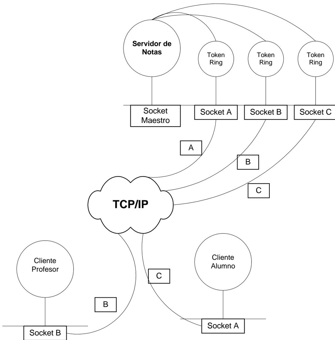
**Fig.2.5.** Diagrama de procesos que conforman la Arquitectura del Servidor y Cliente JAVA.
