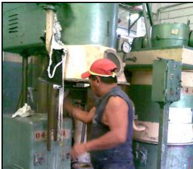
Figura 5.25 Trabajador limpiando con wype las aspas de máquina desaireadora
