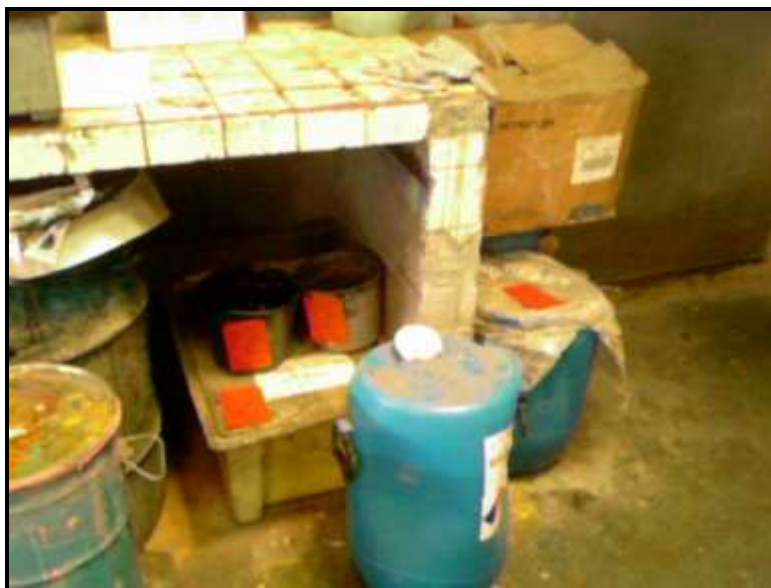
Figura 5.9 Tarjetas rojas sobre varios elementos considerados innecesarios
