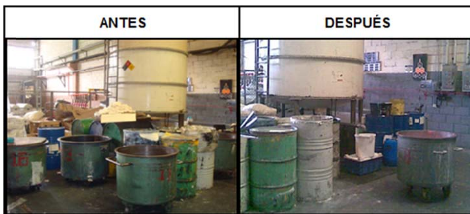
Figura 7.3 Antes y después de la implantación de las 5S
