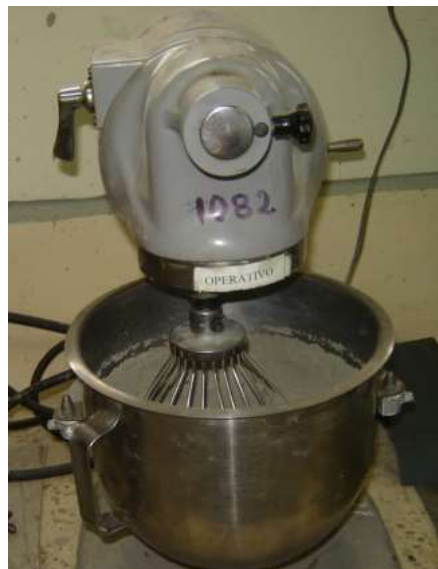
FIGURA 3.10 HOMOGENEIZADO DE LA MEZCLA CEMENTO-ZEOLITA EN SECO
