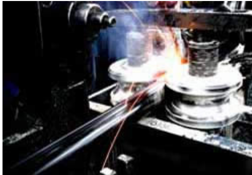
FIGURA 3.1 CONFORMADO DE TUBERIA
