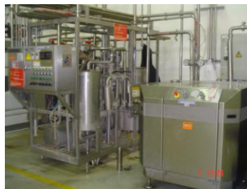
FIGURA 3.3 PASTEURIZACIÓN Y HOMOGENIZADO
