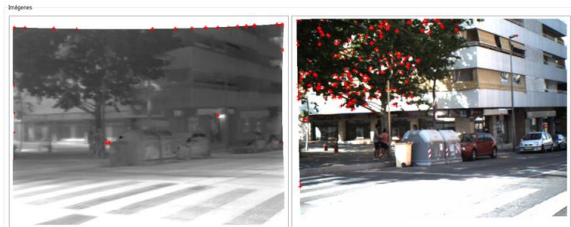
Figura 1. Aplicación del algoritmo de Harris en imágenes LWIR vs. VS.
