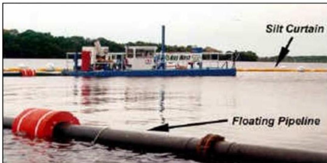
*Fig. 36 Ejemplo de descarga conectado a la draga*
