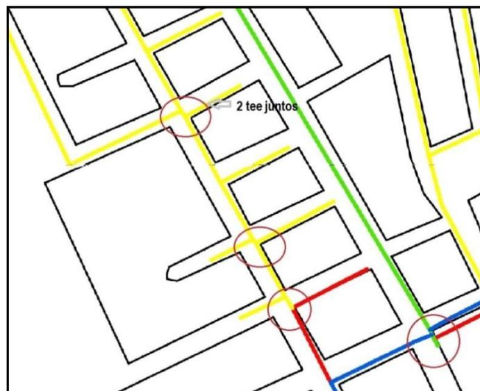
**Figura 4.3 Muestra la utilización de tee en vez de cruz**
