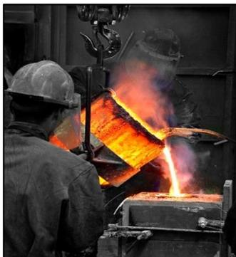
**Figura 3. 15 Proceso de colado en moldes**
