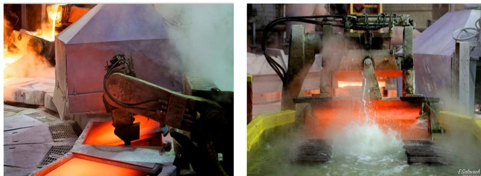
**Figura 3. 7 Proceso de enfriamiento de láminas de cobre (21)**
