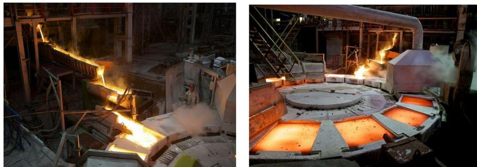
**Figura 3. 6 Rueda de moldeo de cátodos de cobre (21)**
