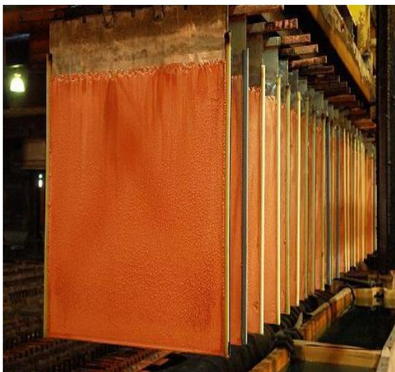
**Figura 2. 6 Cátodo de cobre electrorefinado**
