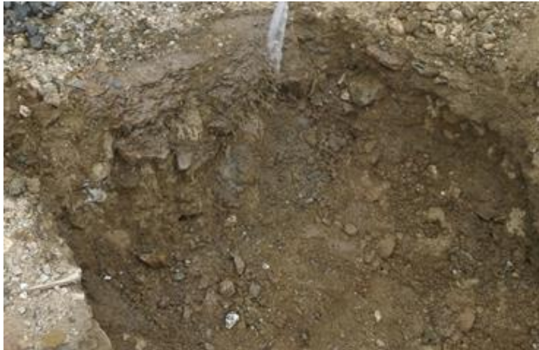
Figura 7: Calicata realizada en terrenos de Espol
