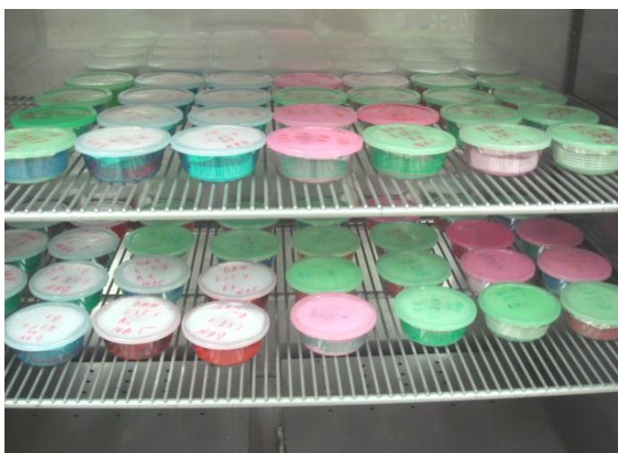
FIGURA 2.4. Método gravimétrico para la construcción de isotermas de sorción del banano en sus diferentes estados de madurez.
