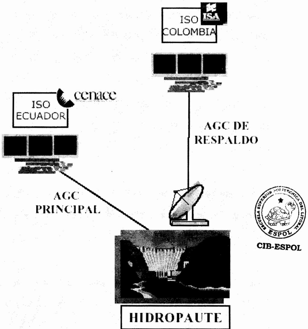
FIGURA 5.2. ACTIVACIÓN DEL AGC DE RESPALDO.
