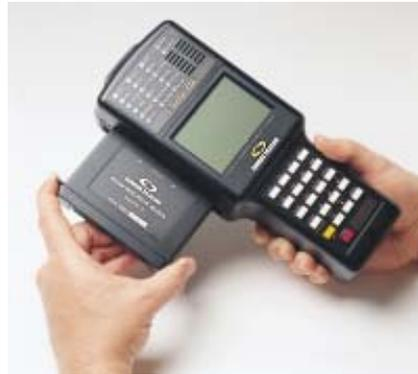
*Figura 4.10 Equipo de prueba xDSL, marca Sunset*
