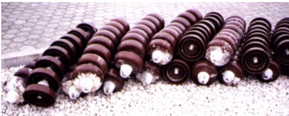
**Figura 5.17 Cadenas Aisladores de Suspensión Retiradas de la L/T Pascuales - Santa Elena a 138 Kv.**
