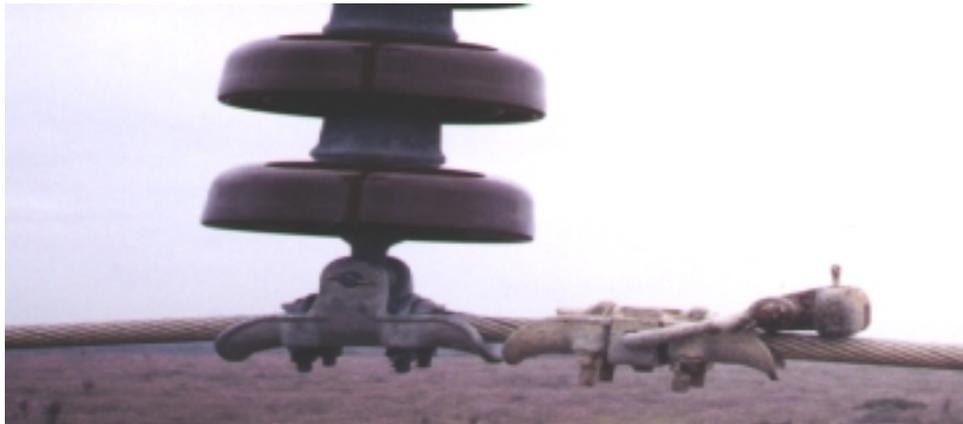
**Figura 11.16 Diferencia entre una grapa de suspensión nueva y una corroída**
