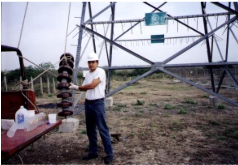
**Figura 11.15** Recolección de muestras de la cadena de aisladores de suspensión ubicado en la Estructura # 237
