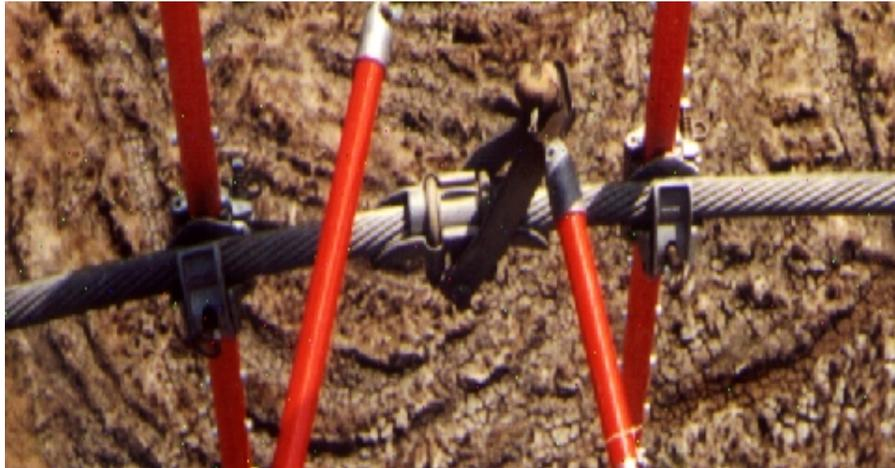
**Fig. 2.7 Corrosión en La rotula Corta**
