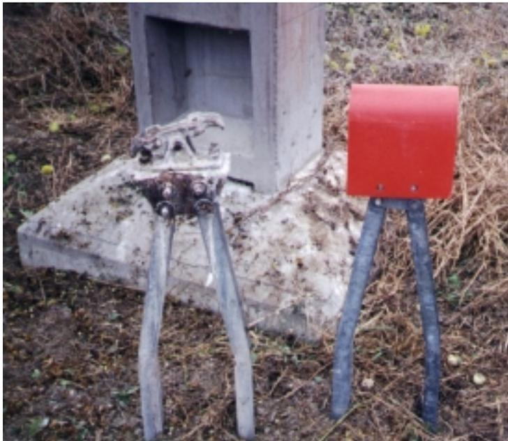
**Figura 11.9 Extensión metálica para poste con su respectivo cobertor plástico.**
