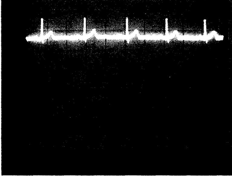
**Figura C.1: Señal de salida del amplificador de instrumentación**
