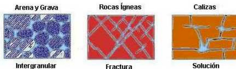
Fig. 2.5.4.- Principales tipos de porosidad.
