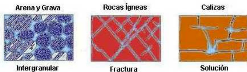
Fig. 2.5.4.- Principales tipos de porosidad.
