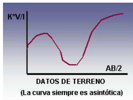
Figura 3.5 Curva de campo de resistividad aparente vs Profundidad
