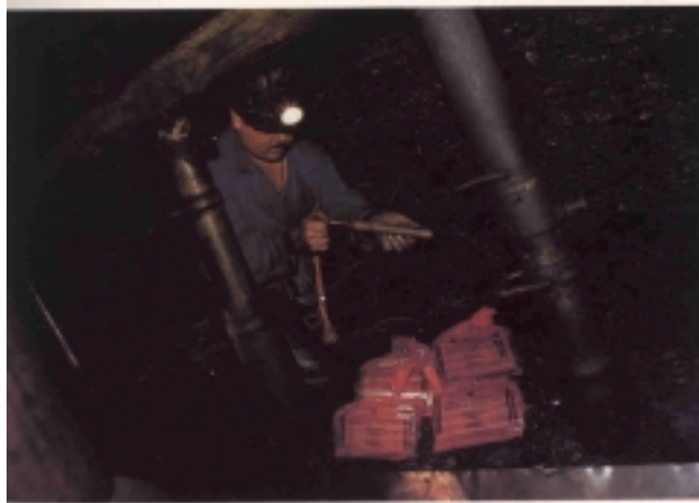
Figura 1. 11 Cebado de un cartucho para voladura de arranque de carbón (Cortesía de UEE, S.A.)
