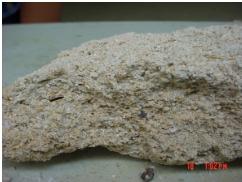
Foto 1. Conglomerado calcáreo con microfósiles.
