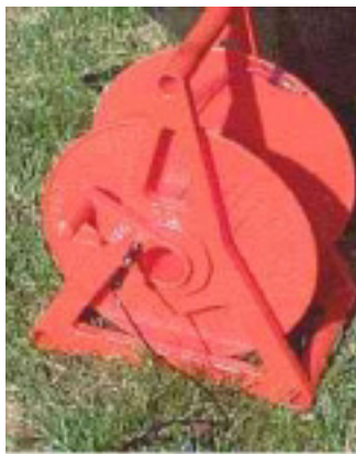
Figura 4.4 Carrete metálico móvil para bobinar el cable.
