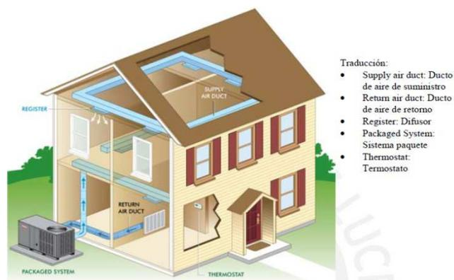
**Figura 1.8 Unidad Paquete exterior enfriado por aire**
