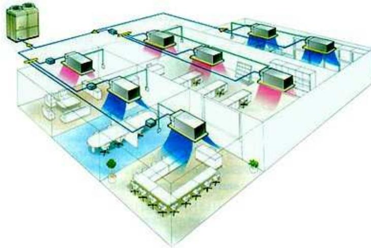
**Figura 1.10 Sistema VRV enfriado por aire**
