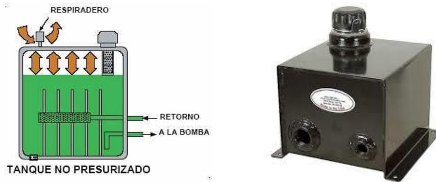
**Figura 1-11 Tanque o depósito hidráulico.**
