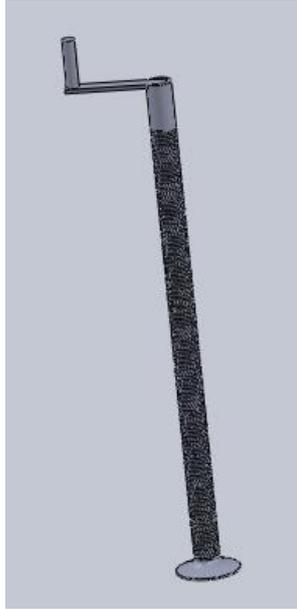
**Figura 3-25 Tornillo de potencia.**
