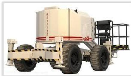
**Figura 1-2 Chasis de Elevador tipo autopropulsado**
