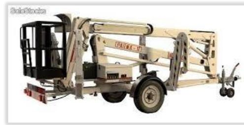
**Figura 1-3 Chasis de Elevador tipo remolque.**
