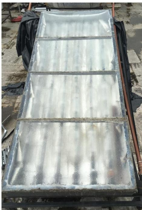
**Figura 3.2: Colector solar que utiliza agua como fluido de transferencia de calor, ubicado a las afueras del Lab. FREE**
