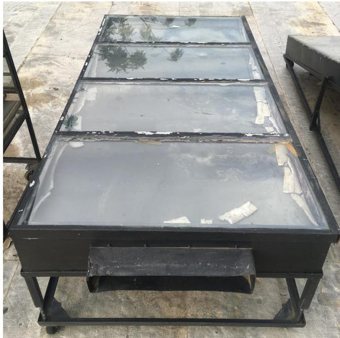
**Figura 3.1: Colector solar que utiliza aire como fluido de transferencia de calor, ubicado a las afueras del Lab. FREE**
