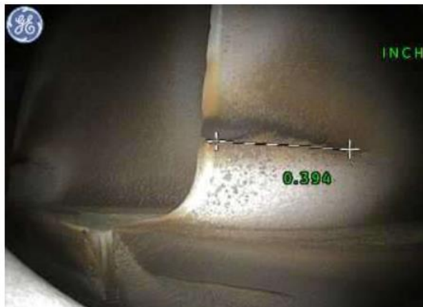
Figura 15: Inspección boroscópica de los álabes móviles de turbina
